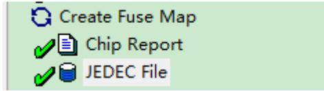
可以右键这里的 JEDEC File，选择 View 看到熔丝图文件，也可以到工程所在的文件夹，找到工程名.jed，这里是 demo.jed，复制出来，就终于可以下载到芯片里啦~O(∩\_∩)O~
