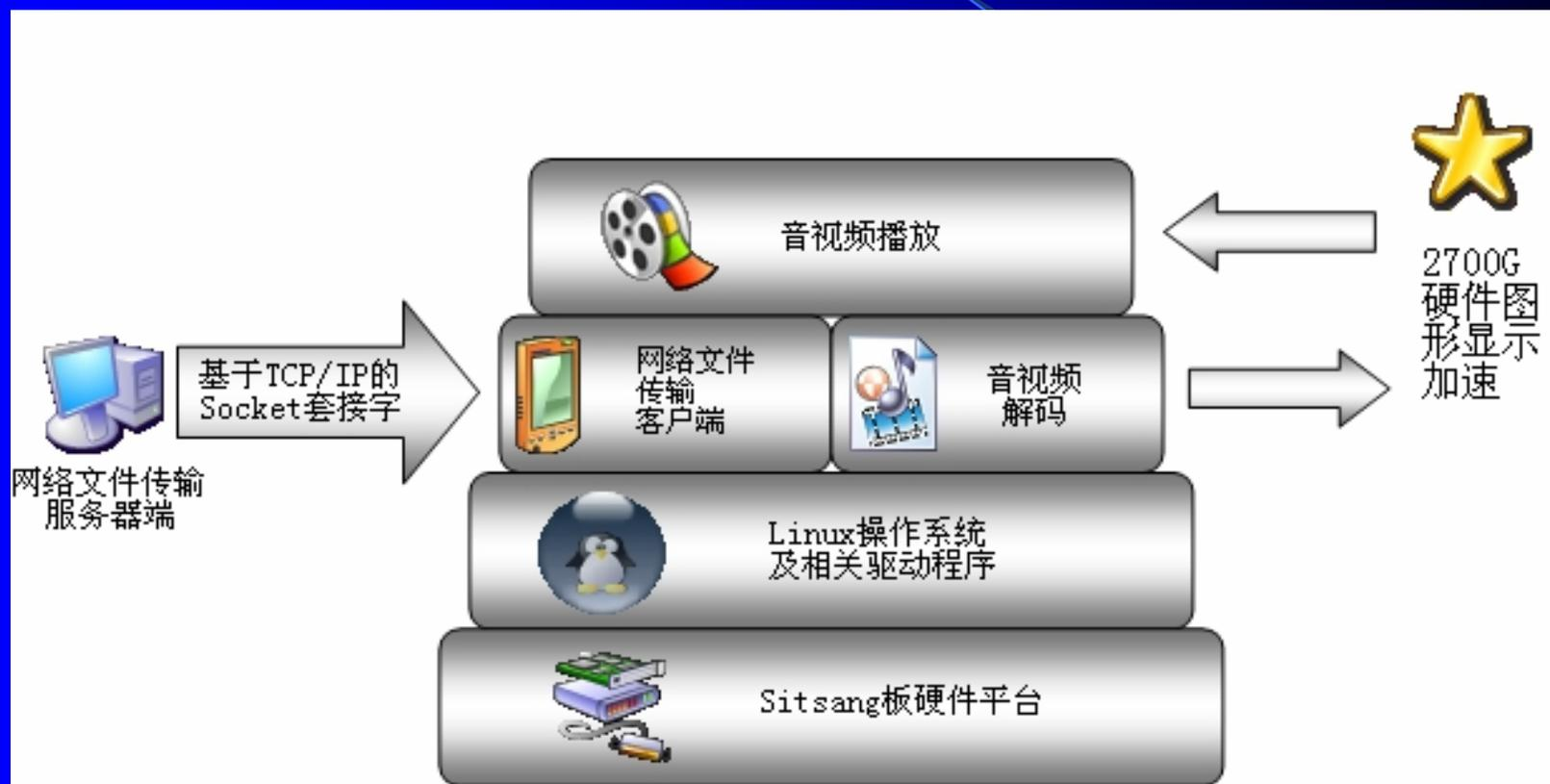
图1.1 系统结构示意图
