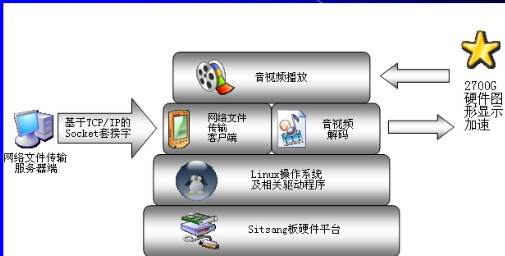
图1.1 系统结构示意图
